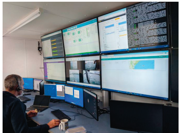
배치된 SoAR은 4G/LTE 및 이리듐 통신을 사용하여 엑서터(Exeter, 英)에 있는 HydroSurv의 해안 원격운영센터에서 관리 및 제어되었다.
