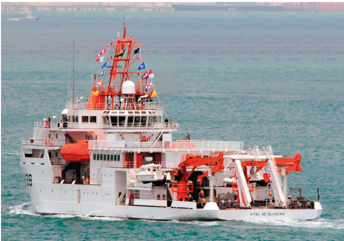
그림 1. 해양조사 선박 '비탈 데 올리베이라(Vital de Oliveira)'는 두 척의 수로측량 보트와 한 척의 원격조정선박(ROV)으로 수로측량을 수행할 수 있다(브라질 해군).
