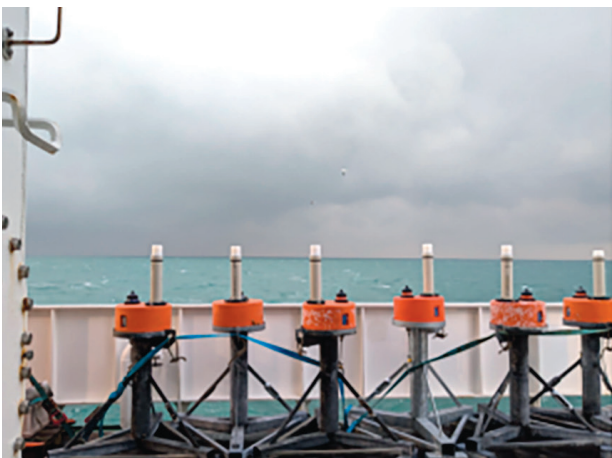
그림 3a. 연구선 벨지카의 갑판에 포유류의 특징적인 울음소리를 감지하기 위해 배치 준비가 완료된 패시브 음향 모니터링 장치. (이미지 제공: S. Paoletti, RBINS)
